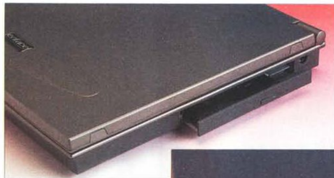
Il lettore DVD è inserito in un cassetto rimovibile sul lato destro dell'apparecchio, mentre sul frontale sono disponibili l'ingresso e l'uscita audio, protette da uno sportellino.
